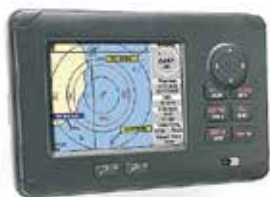
Eksempel på AIS klasse B med farveskærm
